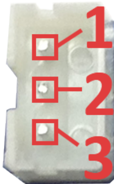
Рисунок 7 – Распиновка разъемов J6-J12
